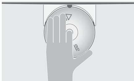
Установите диск в дископриемник таким образом, чтобы боковые кромки диска опирались на боковые опоры дископриемника, а передняя кромка вошла под переднюю опору.
